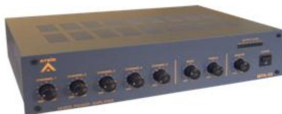
Le préamplificateur amplificateur MPA120 est un boîtier doté de 5 entrées commutables AUX/MIC avec alimentation fantôme sur connectique XLR 3 pts ou sur bornier à vis. Il possède une entrée TEL prioritaire sur toutes les autres entrées ainsi qu'une entrée prioritaire sur les entrées 3 à 6.
