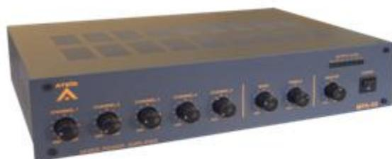
Le préamplificateur amplificateur MPA240 est un boîtier doté de 5 entrées commutables AUX/MIC avec alimentation fantôme sur connectique XLR 3 pts ou sur bornier à vis. Il possède une entrée TEL prioritaire sur toutes les autres entrées ainsi qu'une entrée prioritaire sur les entrées 3 à 6.
