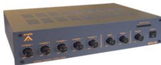
Le préamplificateur amplificateur MPA60 est un boîtier doté de 5 entrées commutables AUX/MIC avec alimentation fantôme sur connectique XLR 3 pts ou sur bornier à vis. Il possède une entrée TEL prioritaire sur toutes les autres entrées ainsi qu'une entrée prioritaire sur les entrées 3 à 6.
